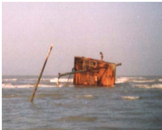
شکل ۱۰- جک آپ بارج ساحل ۱۰۶ پس از واژگونی
